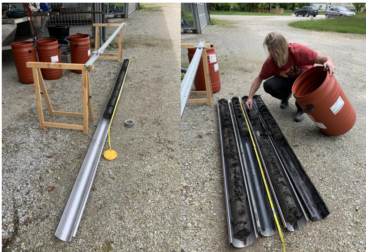
Obr. 4. Příklad vytlačeného sedimentu ve žlabu a míchání směsných vzorků.
